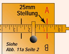
Der Cutter Gauge kompensiert für den Schneidrädchen-Abstand, und wird nur zur Einstellung verwendet.
