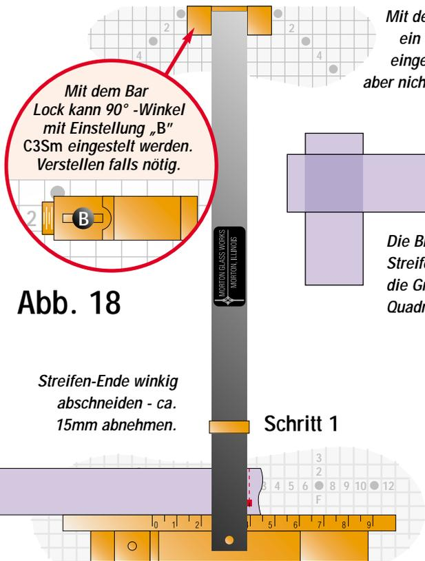
Mit dem Bar Lock kann 90° -Winkel mit Einstellung „B“ C3Sm eingestellt werden. Verstellen falls nötig.
